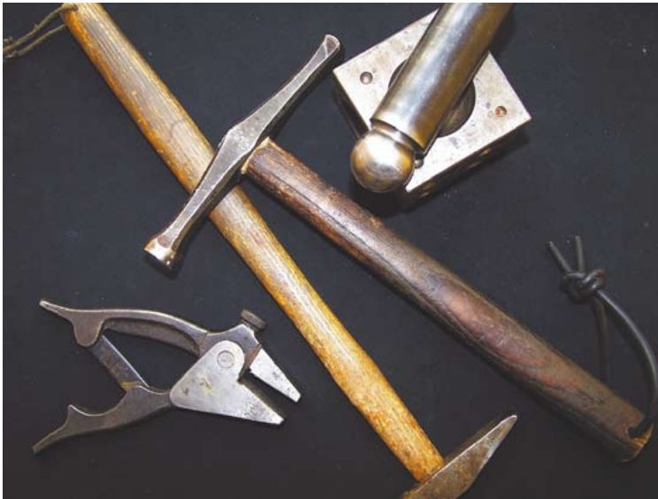
Das Werkzeug eines Goldschmiedes: Schmiedehämmer, Würfelfugelanke, Schnallzange
